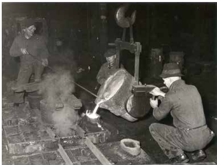
1955 | Het gieten van pompen in eigen gieterij | F Archief Begemann
